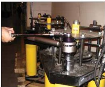
◀ Мультипликатора Enerpac E393 с опорной штангой используется для ручной закрутки болтов с моментом до 4300 Нм.
